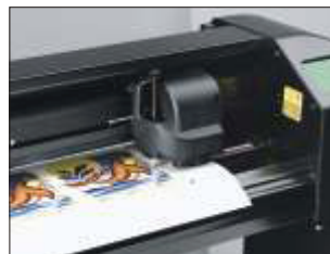
OPOS zum Konturschneiden von gedruckten Vorlagen
