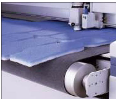
Schaumstoff auf Conveyor
